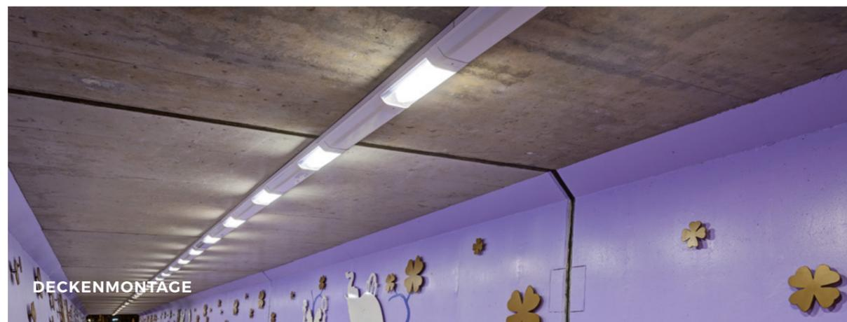
► Die VENTEGO verfügt über eine Standard-Durchgangsverdrahtung im Gehäuse der Leuchte. Das hat den Vorteil, dass die Lichtlinie auch dann intakt bleibt, wenn eine einzelne Leuchte ausfällt. Serienmäßig sind Fangdrähte angebracht, mit denen die Elektroplatte bei der Montage am Gehäuse befestigt werden kann.
